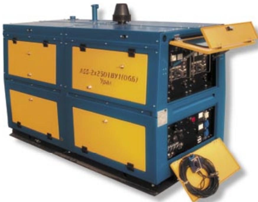
Агрегат предназначен для питания двух независимых постов ручной дуговой сварки покрытым электродом, а также для питания электроинструмента и освещения при автономной работе в полевых условиях.
